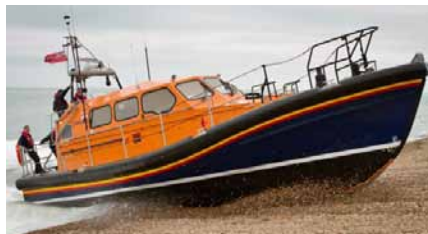
Lodě Shannon jsou konstruovány tak, aby mohly vyjet na pláž.
